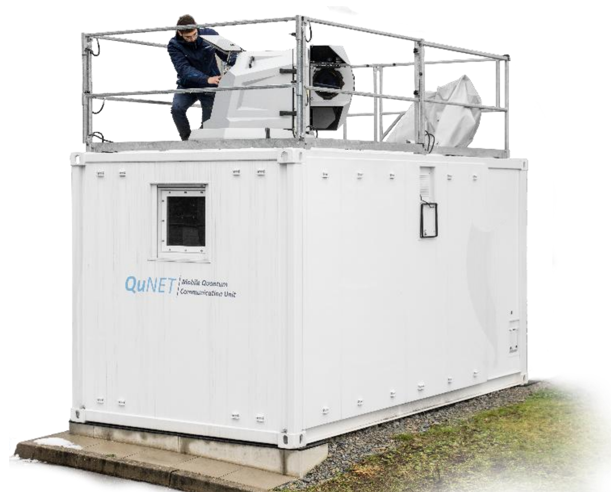
Mobiler Laborcontainer QuBUS als Bindeglied zwischen einer ad hoc aufgebauten Freistrahlsverbindung und einem Glasfasernetz
